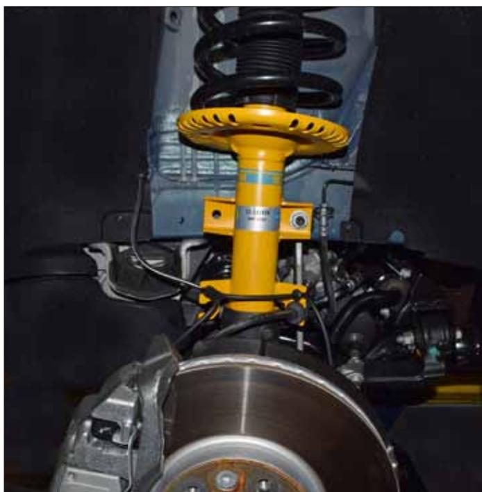
Fahrzeughöherlegung, Federdistanz-Satz mit Bilstein Stoßdämpfersatz +25 mm,
