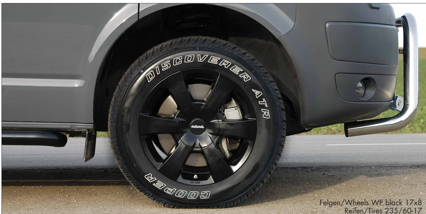
Felgen/Wheels WP black 17x8, Reifen/Tires 235/60-17 Fahrzeughöherlegung, Federdistanz-Satz mit Bilstein Stoßdämpfersatz +35 mm Suspension distance kit with Bilstein Shock absorbed +35 mm
