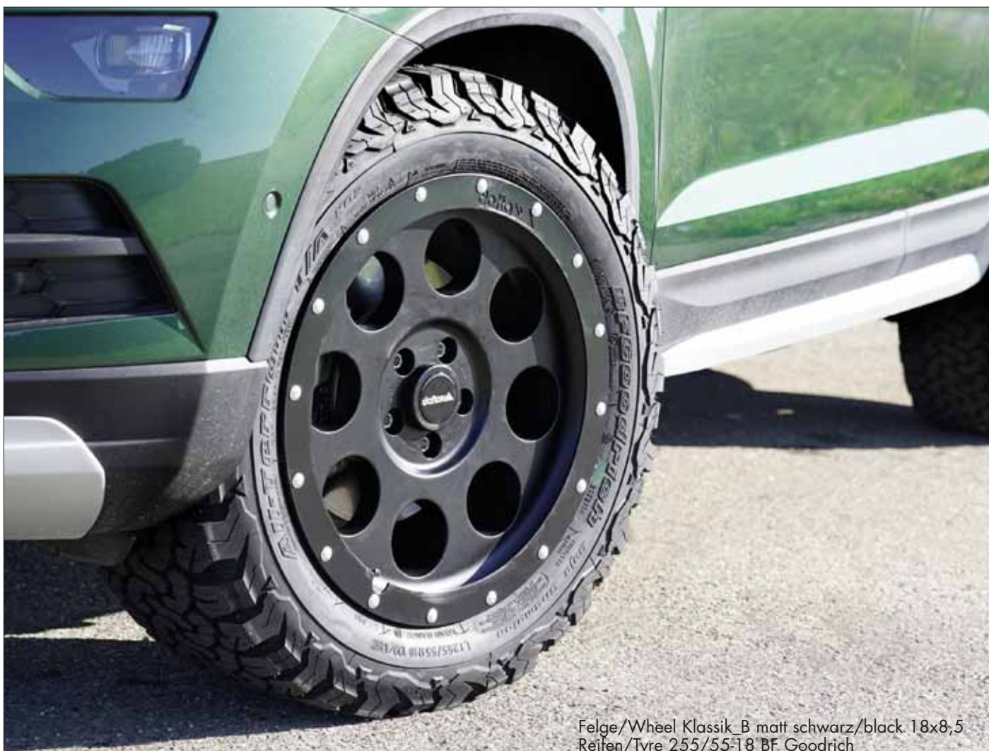
Felgen/Wheels Klassik_B matt schwarz/black 18x8,5 Reifen/Tyre 255/55-18 BF Goodrich Höherlegung/Body Lift Kit 20 mm
