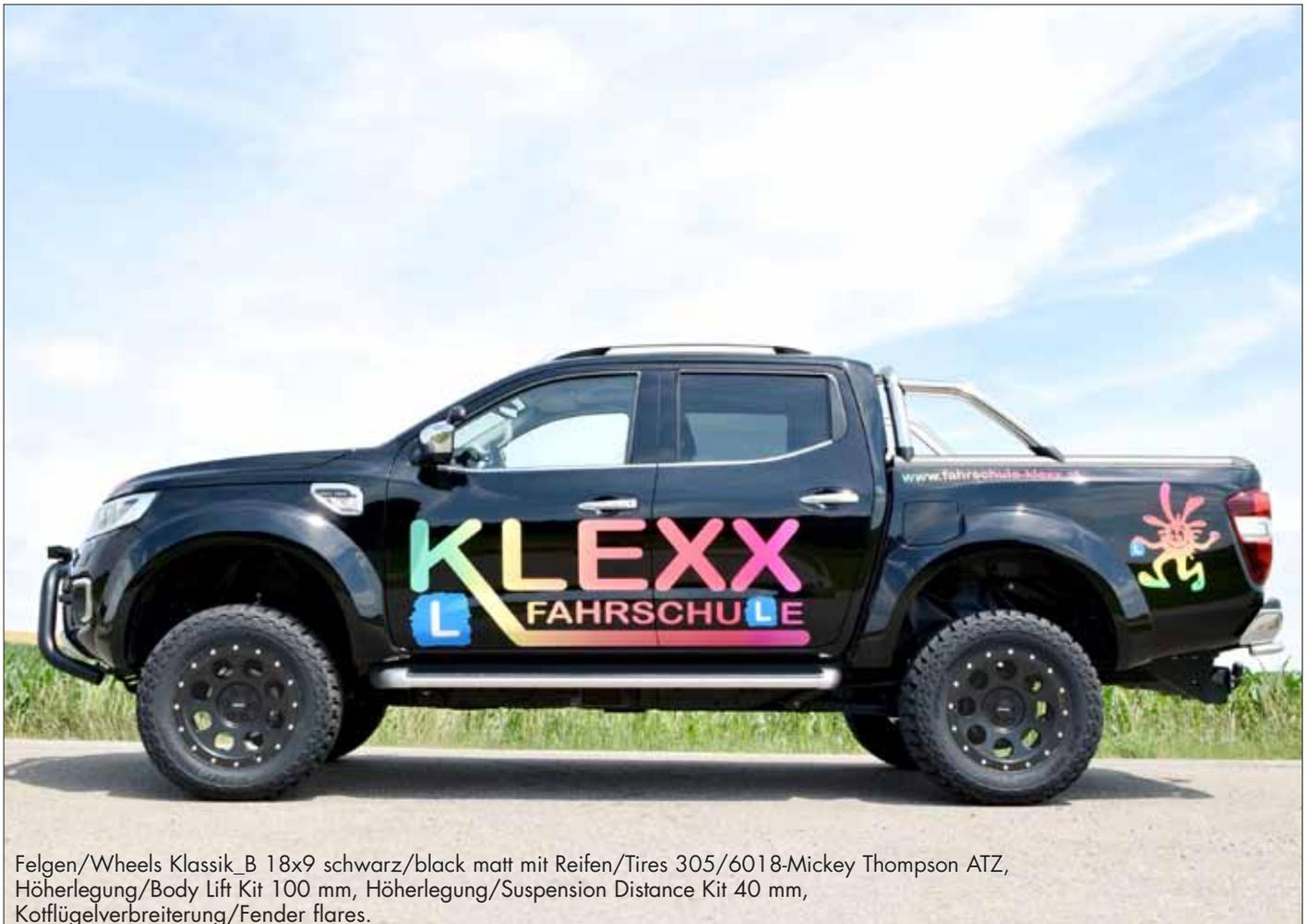
Felgen/Wheels Klassik\_B 18x9 schwarz/black matt mit Reifen/Tires 305/6018-Mickey Thompson ATZ, Höherlegung/Body Lift Kit 100 mm, Höherlegung/Suspension Distance Kit 40 mm, Kotflügelverbreiterung/Fender flares.
