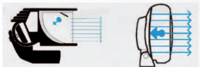
LED-Licht wird von Reflektoren gebündelt. Dadurch mehr gezielte Ausleuchtung bei weniger Energie. Reflector Facing Technology.
